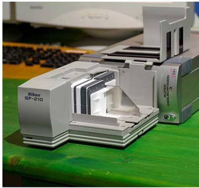
Scanner mit angesetzten Feeder
